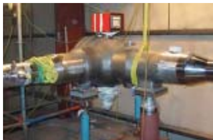
Das eingebaute Turbinenventil
