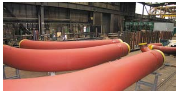
Versandfertige Spools in der Abnahme.
